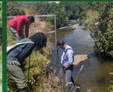
Lugar de instalación con sensor de nivel y turbidímetro.
