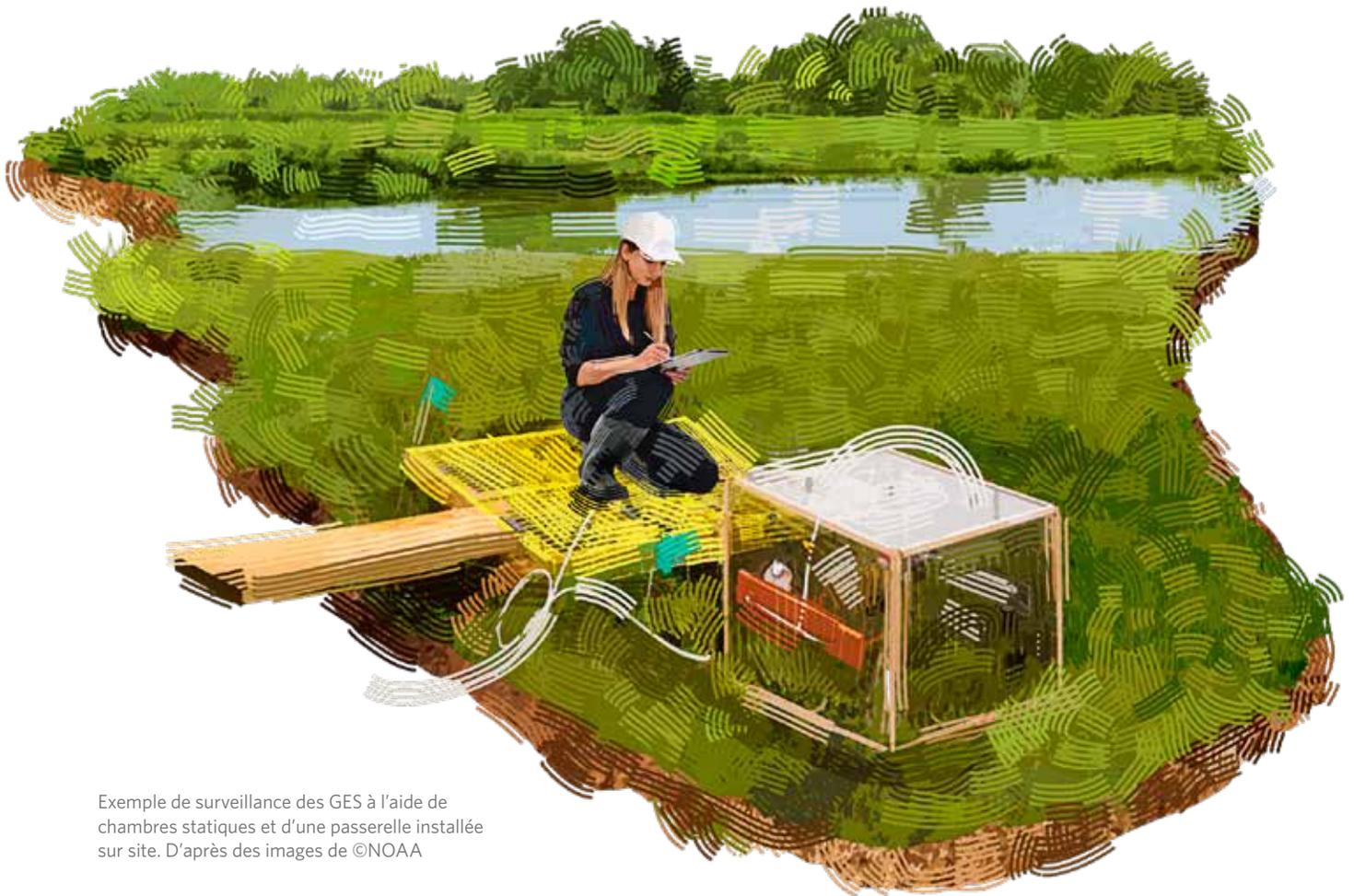
Exemple de surveillance des GES à l'aide de chambres statiques et d'une passerelle installée sur site. D'après des images de ©NOAA
