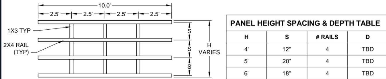
TYPICAL PREFABRICATED FENCE PANEL
