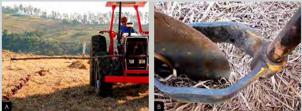
Figura 41: Uso de um pedaço de madeira com uma corrente em sua extremidade para a orientação da subsolagem em relação à linha adjacente (A) e disco de corte do subsolador cortando a palhada já seca (B).
